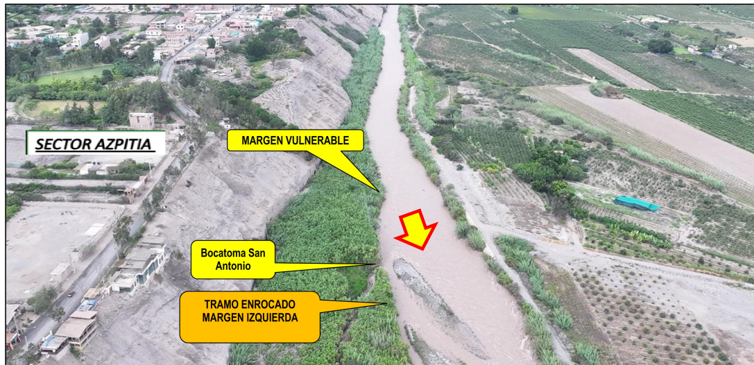
FIGURA N°01: MARGEN DERECHA DEL RIO MALA DONDE SE APRECIA LA BOCATOMA Y EL CANAL SAN ANTONIO EXPUESTOS
